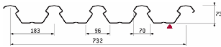
Rys. 07- Blacha trapezowa Cofrastra 70 P. Przekrój.
